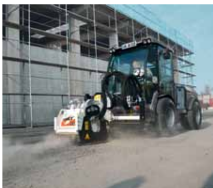
MIC 84, fréza na asfalt
